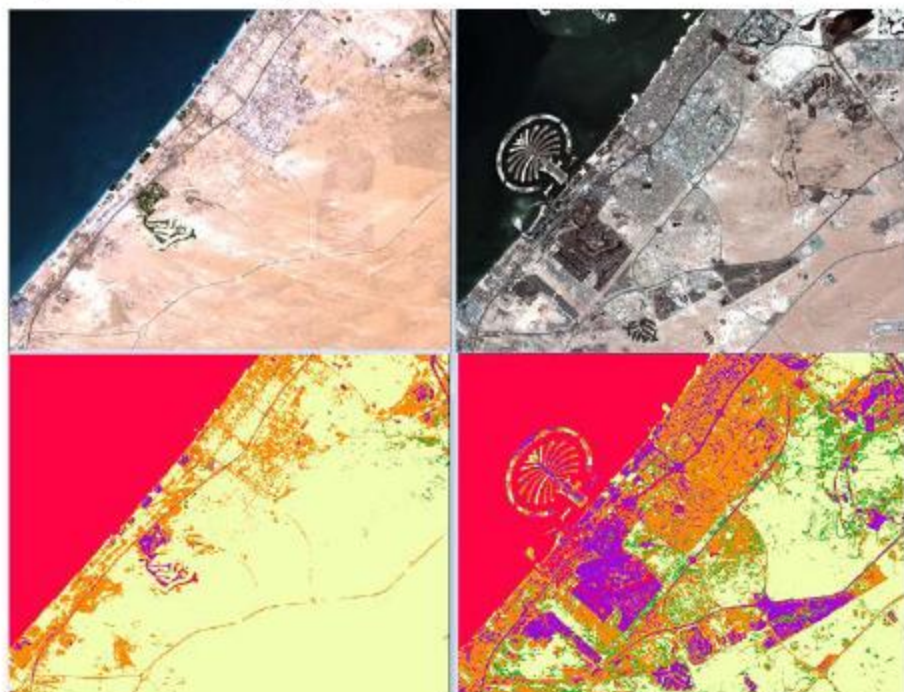
Slika 3: Barvni kompozit in klasifikacija z metodo najmanjše razdalje južnega dela Dubaja leta 2000 in 2013.
