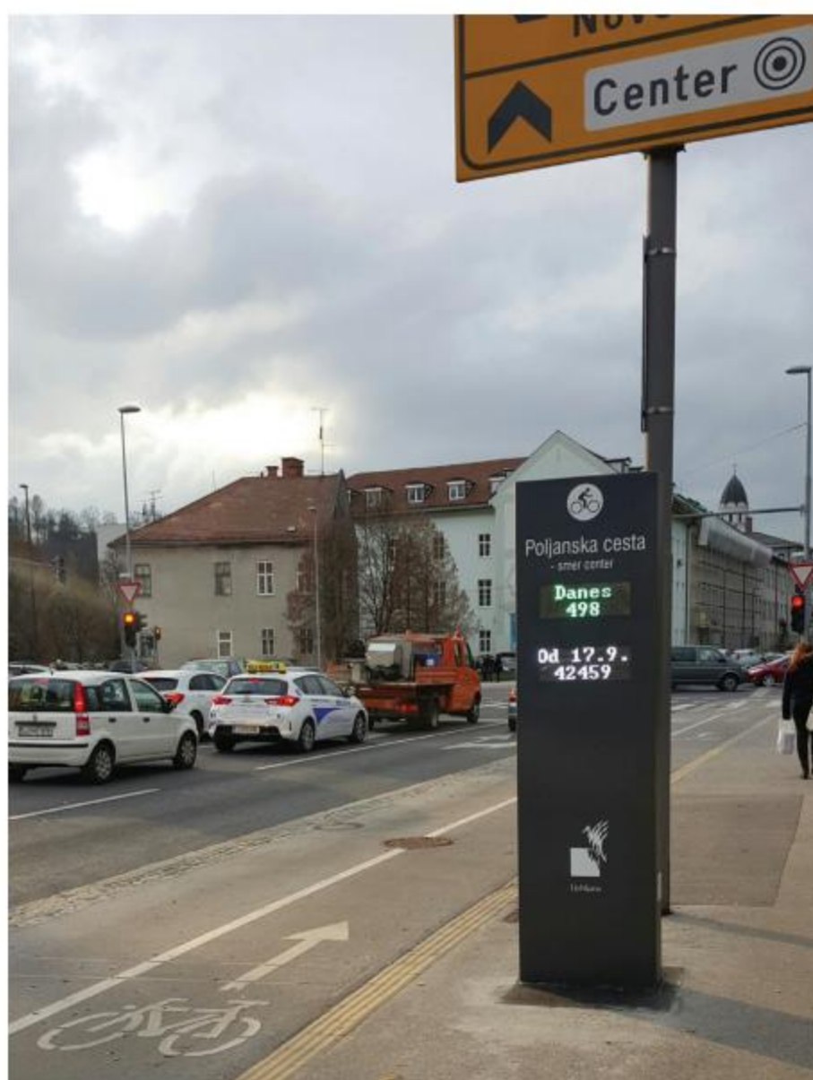
Slika 1: Eden izmed na novo postavljenih kolesarskih števec v letu 2015, ki stoji na križišču Poljanske in Roške ceste. Števec s pnevmatskimi tubami avtomatsko beleži število kolesarjev, hkrati pa prikazuje dnevno ter celotno število mimoidočih kolesarjev (foto: Peter Žnidaršič, 2016).
